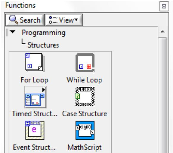
Las estructuras se comportan como cualquier otro nodo en el diagrama de bloques, ejecutando automáticamente lo que está programado en su interior una vez tiene disponibles los datos de entrada, y una vez ejecutadas las instrucciones requeridas, Suministran los correspondientes valores a los cables unidos a sus salidas. Sin embargo, Cada estructura ejecuta su *subdiagrama* de acuerdo con las reglas específicas que rigen su Comportamiento, y que se especifican a continuación.
